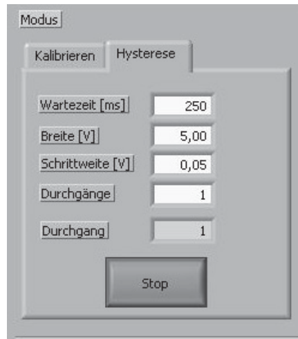
Abbildung 30: Benutzeroberfläche des LabVIEW-Messprogramms zum Messen von Hysteresen.
