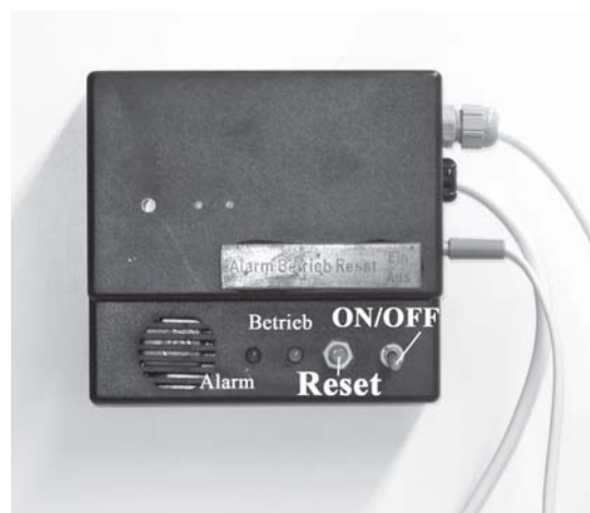
Abbildung 33: Sicherheitsschaltung für das Magnetsperrventil
